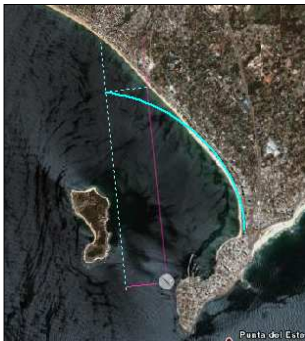
Figura 48.- Parábola de equilibrio para el tramo 6 (Punta Ballena – Punta del Este) controlado por la punta del Este. Se muestra el frente de oleaje de la dirección de la resultante de energía y la curva de equilibrio estático.
