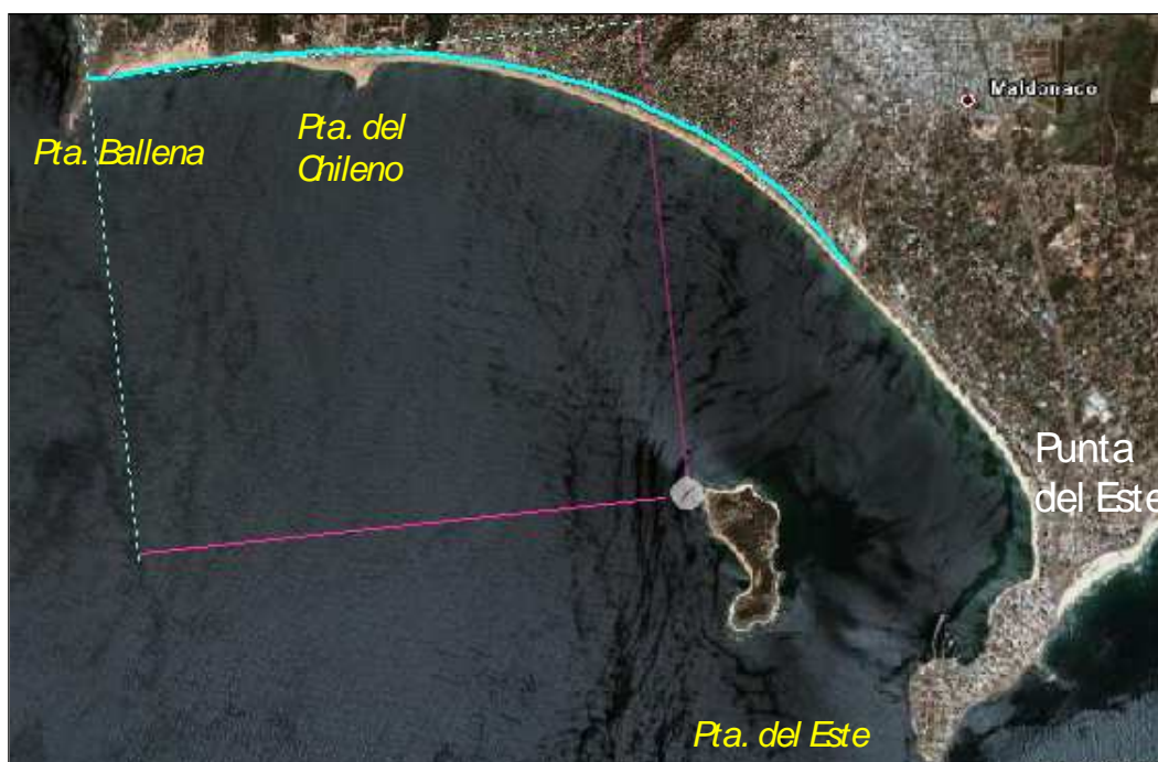
Figura 47.- Parábola de equilibrio para el tramo 6 (Punta Ballena – Punta del Este) controlado por la isla Gorriti. Se muestra el frente de oleaje de la dirección de la resultante de energía y la curva de equilibrio estático.
