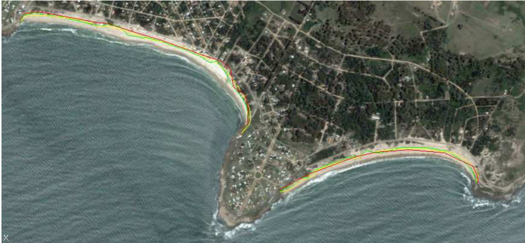
Figura 56.- Evolución de la línea de costa en el tramo 4 (Punta Imán – Punta Negra). Año 1966 (rojo). Año 1980 (anaranjado). Año 2007 (verde)
