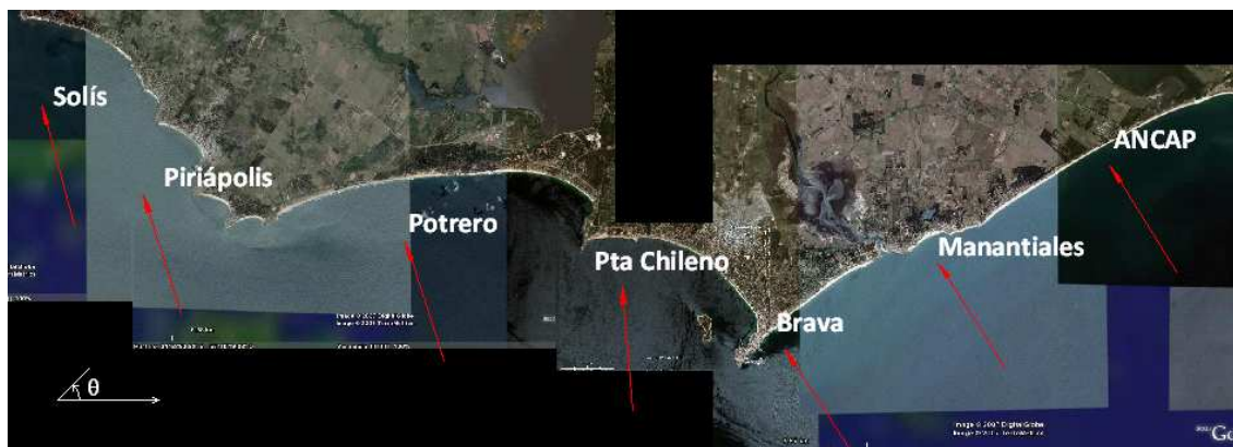
Figura 26.- Dirección del flujo medio anual de energía dado por el clima de olas
