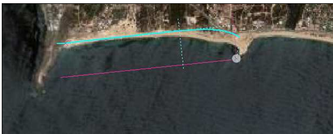
Figura 49.- Parábola de equilibrio para el tramo 6 (Punta Ballena – Punta del Este) controlado por la punta del Chileno. Se muestra el frente de oleaje de la dirección de la resultante de energía y la curva de equilibrio estático.
