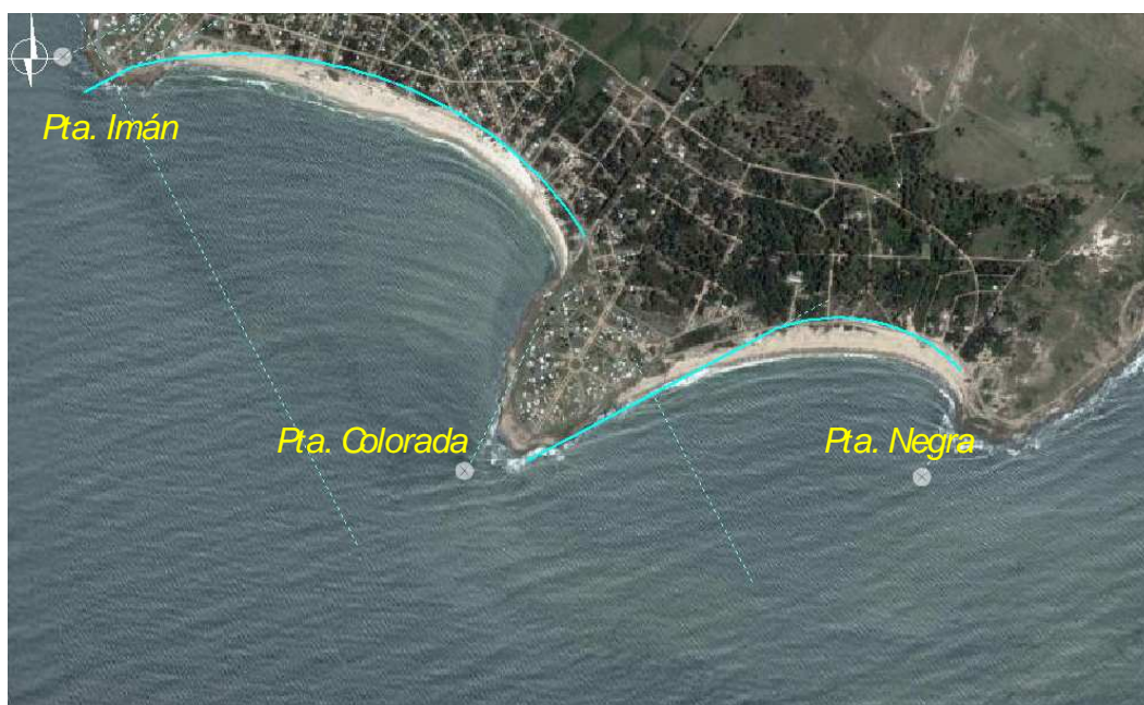
Figura 44.- Parábola de equilibrio del tramo 4 (Punta Imán – Punta Negra). Se muestra la dirección de la resultante de energía del oleaje y la curva de equilibrio estático teniendo en cuenta los puntos de control considerados.
