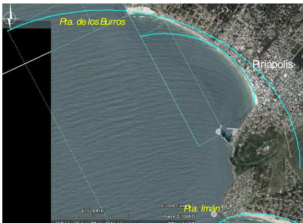
Figura 43.- Parábola de equilibrio del tramo 3 (Piriápolis). Se muestra la dirección de la resultante de energía del oleaje y la curva de equilibrio estático teniendo en cuenta como punto de control el puerto de Piriápolis y la punta Imán.
