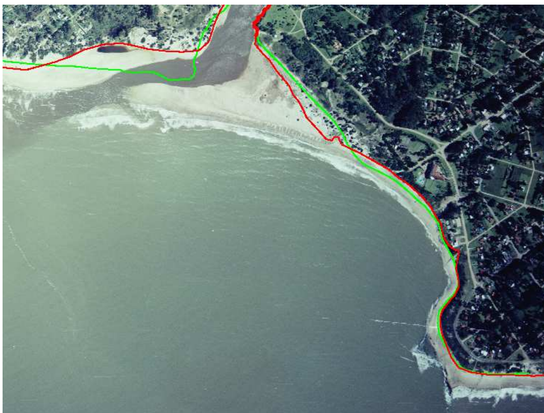
Figura 53.- Evolución de la línea de costa en el tramo 1 (Solís). Año 1980 (verde). Año 2007 (rojo y foto).
