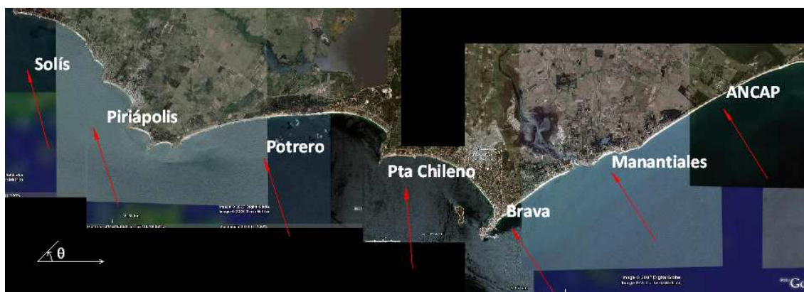
Figura 40.- Dirección del flujo medio anual de energía dado por el clima de olas
